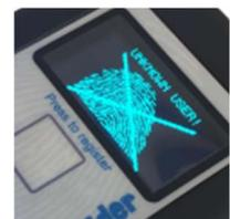
Il lettore Bio-Buddy permette un processo di auto-registrazione fornendo all'utente istruzioni facili da seguire. Al primo utilizzo l'utente preme il pulsante di registrazione sotto il display e posiziona il dito sul display per tre volte. Questo permette la registrazione della impronta digitale nel lettore e crea un numero univoco.
